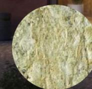
Утеплитель: минеральная вата толщиной 150 мм
